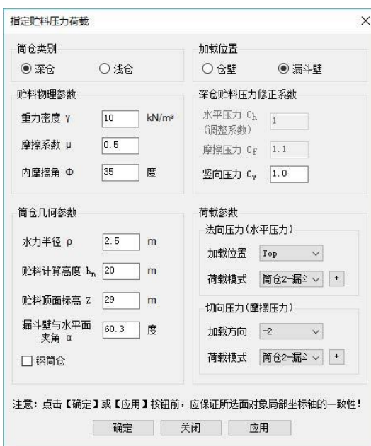
图 4.6b 筒仓 2 漏斗壁荷载设置参数
