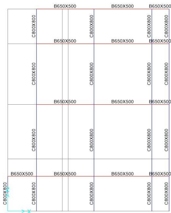
图 2.2 绘制平面框架
