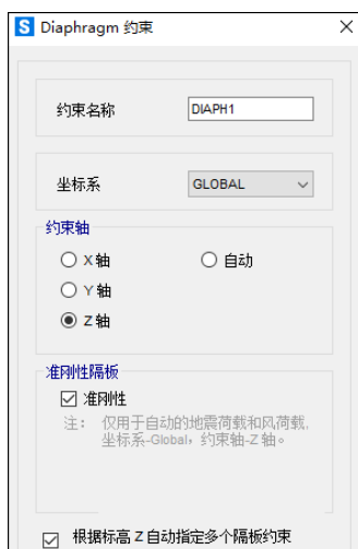
图 4.4 定义准刚性隔板
