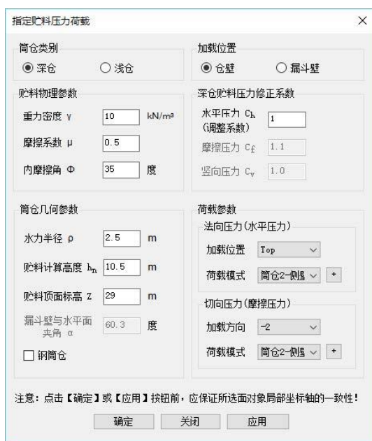
图 4.6a 筒仓 2 仓壁荷载设置参数
