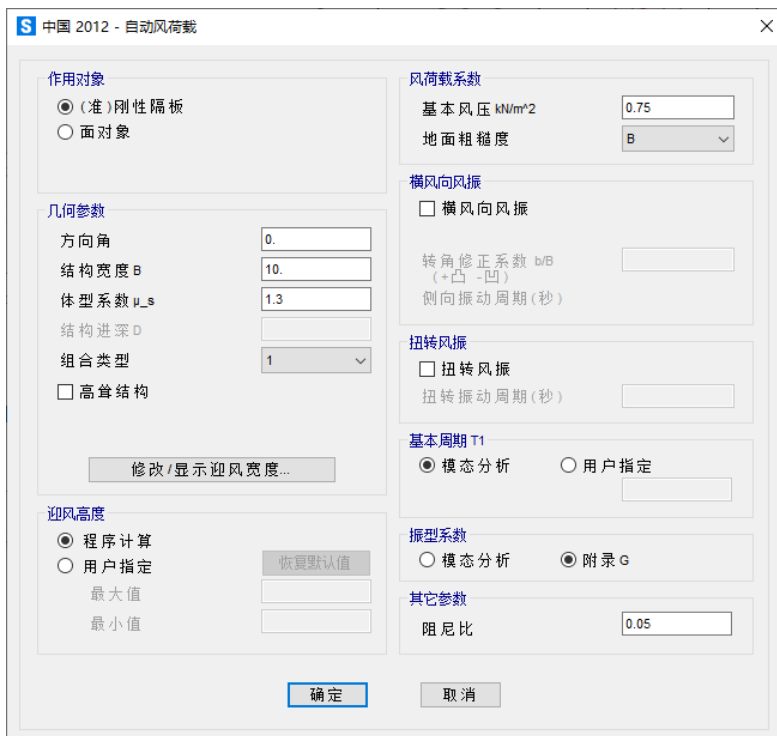
图 4.3 X 向风荷载定义参数
